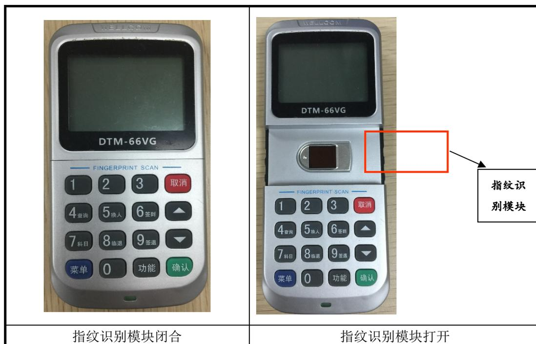
如上图所示，指纹识别模块在学时记录仪中清晰可见，教练员、学员通过按压手指，输入指纹信息，设备将输入的指纹信息与数据库中记录的指纹信息进行比对，确保教练员、学员的身份真实有效，防止学时造假。
