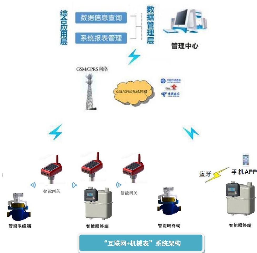
**无线智能眼通讯网关：**属于连接器，可实现网络互连，采用太阳能+锂电池方式联合供电，带蓝牙调试功能，可同时管理区域内多个无线智能眼远传终端。
