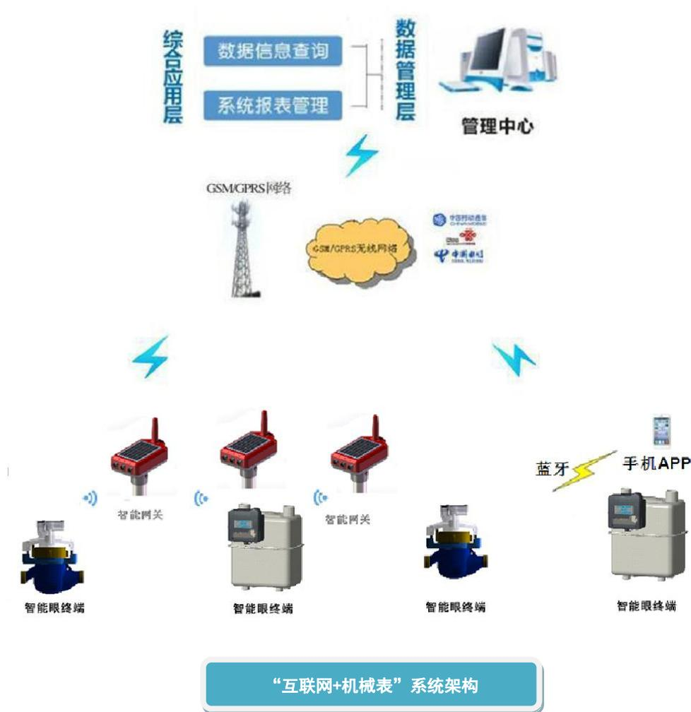
无线智能眼通讯网关：属于连接器，可实现网络互连，采用太阳能+锂电池方式联合供电，带蓝牙调试功能，可同时管理区域内多个无线智能眼远传终端。
