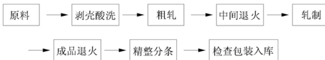
钢管工艺流程图
