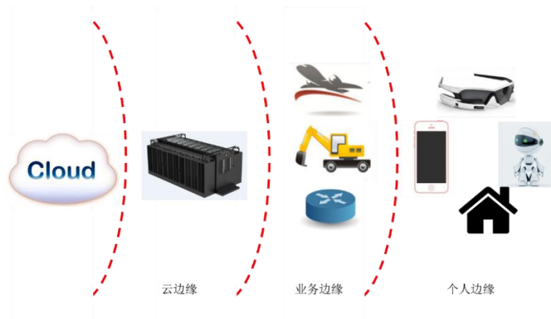
图 1 边缘计算三类场景：云边缘/业务边缘/个人边缘
