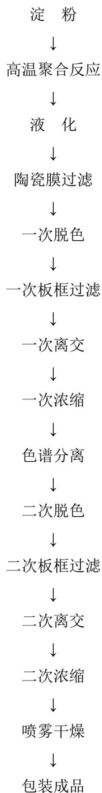
图 5.1.3 抗性糊精生产工艺流程示意图
