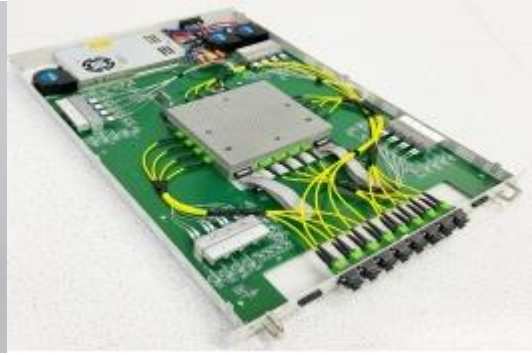
图 5. 量产版 400G QSFP-DD DR4 硅光模块
