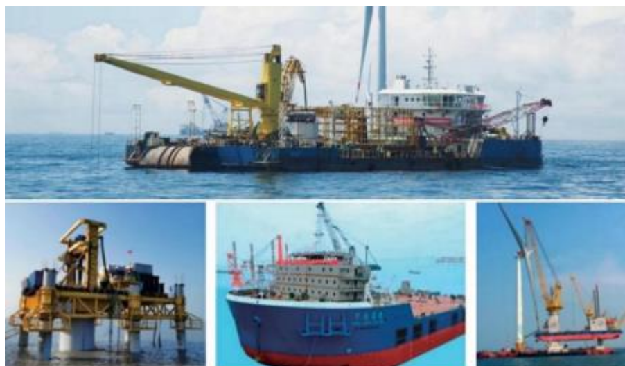
图 15 部分海上施工船（敷缆、嵌岩、吊装等）
