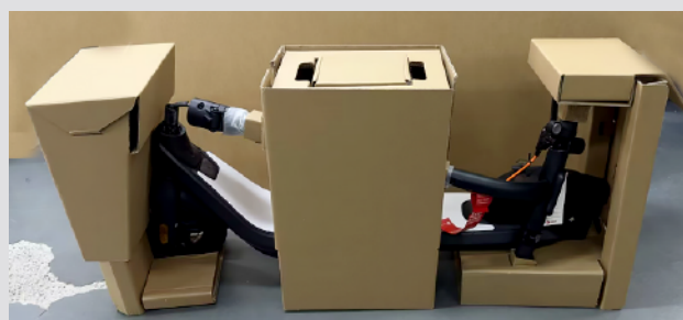
二代智能割草机器人、电动滑板车全纸化包装设计
