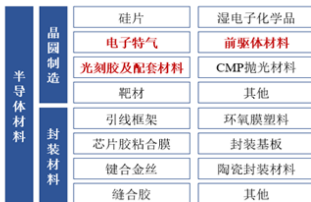
半导体制造主要材料示意图
