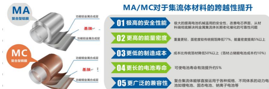
复合集流体之复合铜箔和复合铝箔产品结构图
