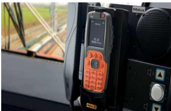
▲ 桑达 OPH-810R 装配在高铁驾驶室操作台，与调度指挥中心保持即时通信
