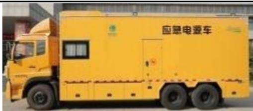
300-1000kW 低压应急电源车
