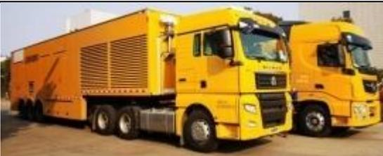
2000kW/10KV 中压电源车
