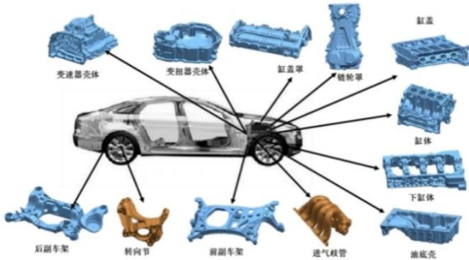
铸造工艺中的压铸具有熔融合金填充速度快、生产效率高、操作简单的特点，易实现机械化和自动化，可用来生产大型、薄壁、复杂的汽车车身结构件。采用铝合金压铸工艺生产的结构件，具有重量轻、韧度高以及力学性能好等特点，在汽车上具有较好的应用前景。近年来，在汽车轻量化不断加速的大背景下，国内外各大汽车厂商均已大规模使用铝合金压铸结构件替代传统的钢质或铁质冷冲压结构件。目前，压铸模具可用来生产汽车减震塔、内扭矩壳体、外扭矩壳体、仪表板、H柱、门框、后横梁、后纵梁、行李箱框、中通道等多种汽车车身结构件，具体如下：
