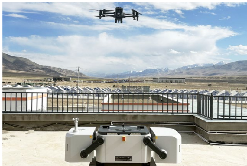
福塔电站引入无人机空中 AI 巡检，助力光伏电站智慧运维
