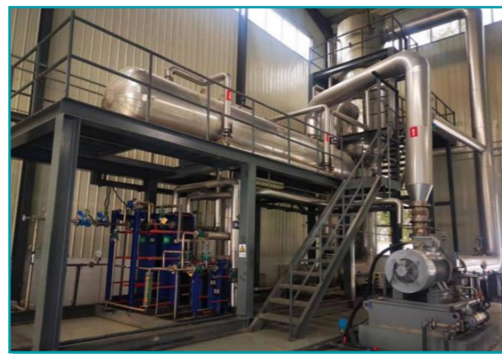
“有机固废资源化循环利用关键技术研究产业化”项目 MVR 设备
