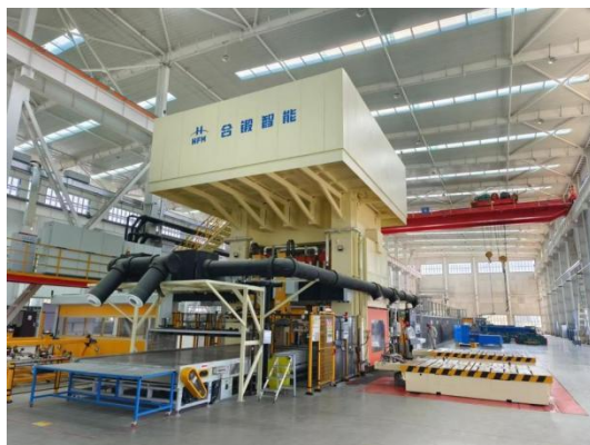
超高强钢直接热冲压成形生产线
