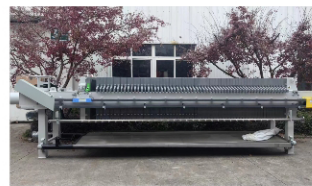
购置新污泥压滤机 缩短过滤时间，减少能源使用
