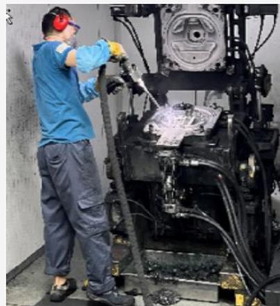
员工使用干冰清洗机清洗模具
