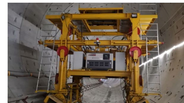
水电七局研制了地铁隧道维护无轨自行式平台车，已成功应用于国内轨道交通隧道后期维护工程，总体达到国际先进水平。
