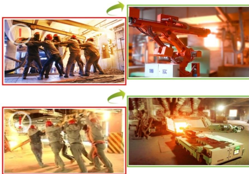
图示：公司针对电石矿热炉领域出炉机器人、捣炉机器人替代人工作业示意图
