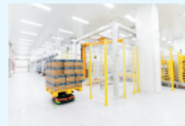
正在现场自动运输的AGV小车
