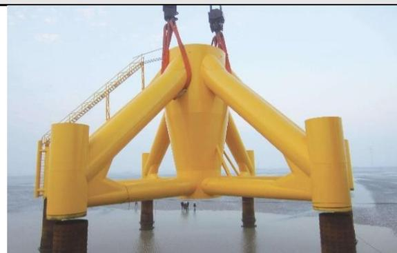
公司生产的导管架是海上风电设备的组合式支撑基础，由上部钢制桁架与下部多桩组配而成，上端与风电塔筒相连、下端嵌入海床地基中，起到连接和支撑作用，适用于复杂地质地貌的海洋环境。
