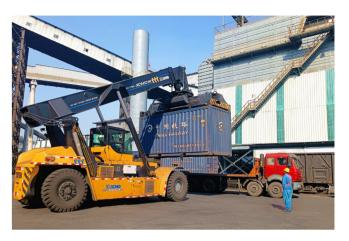
正面吊卸车设备进行卸车作业 Unloading Operations by a Reach Stacker
