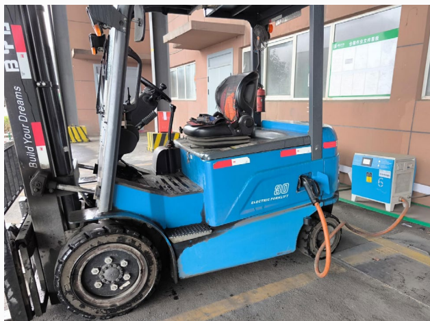
在工厂使用锂电四轮平衡重叉车转运和装卸货物
