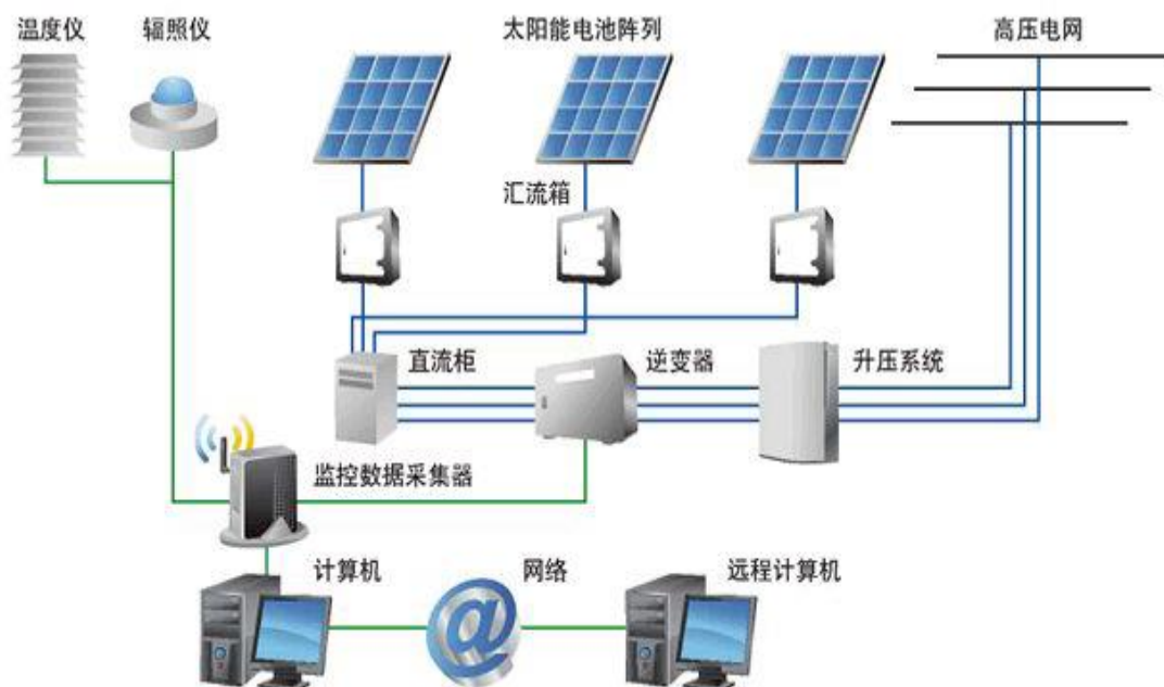
组串式逆变器发电示意图
