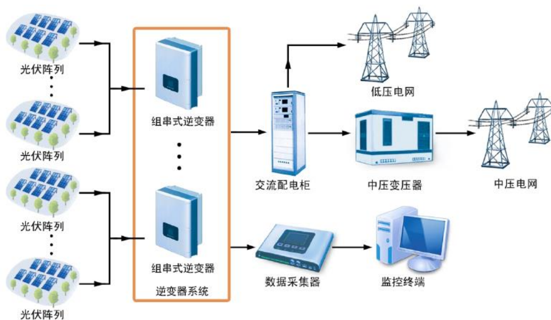
组串式逆变器发电示意图
