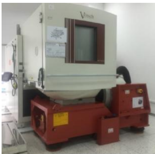
图 4-6 摇晃震动试验台
