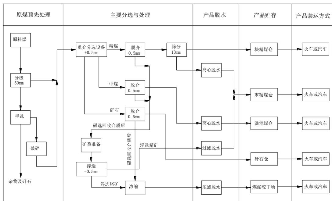
原煤经井工、露天开采，运输至地面洗选加工系统。发行人煤炭业务流程如上图所示。原煤经预先分级，大于规定粒级经过人工捡杂后，破碎到规定粒级以下与原煤分级筛下原煤混合进入重介分选系统和浮选系统分选。重介分选设备分选出精煤、中煤、矸石三种产品。重介精煤、中煤、矸石经脱介、脱水后作为精煤、洗混煤、矸石等产品，经运输至相应的产品仓。重介精煤根据需要可筛分为不同粒级产品，主要分为块精煤和末精煤产品，并进入各自产品仓。细粒级煤炭经浮选工艺分选出浮选精矿和浮选尾矿，浮选精矿经过滤脱水后，作为精煤产品；
