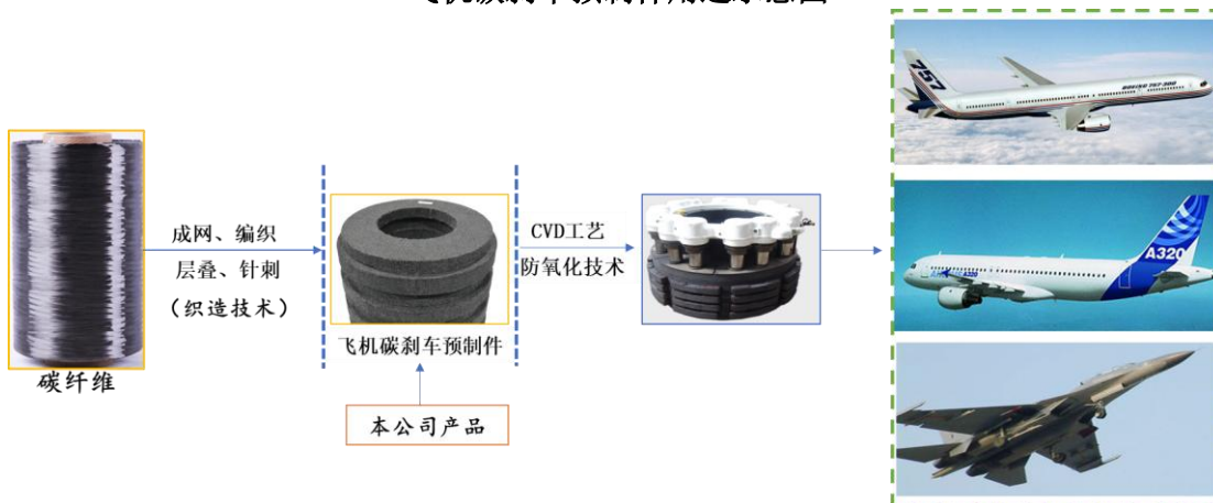
飞机碳刹车预制件用途示意图
