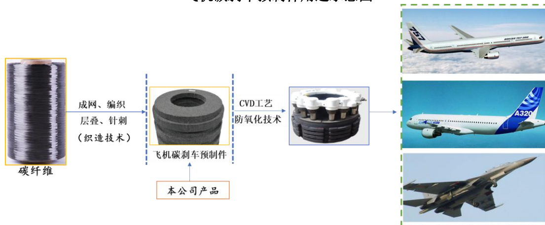
飞机碳刹车预制件用途示意图
