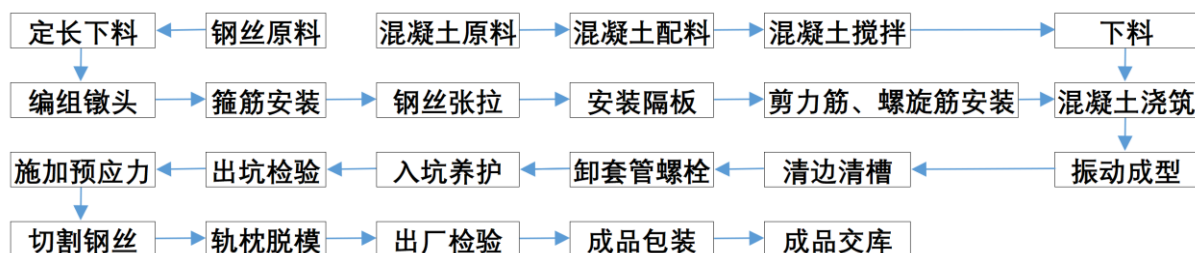
轨枕工艺流程图
