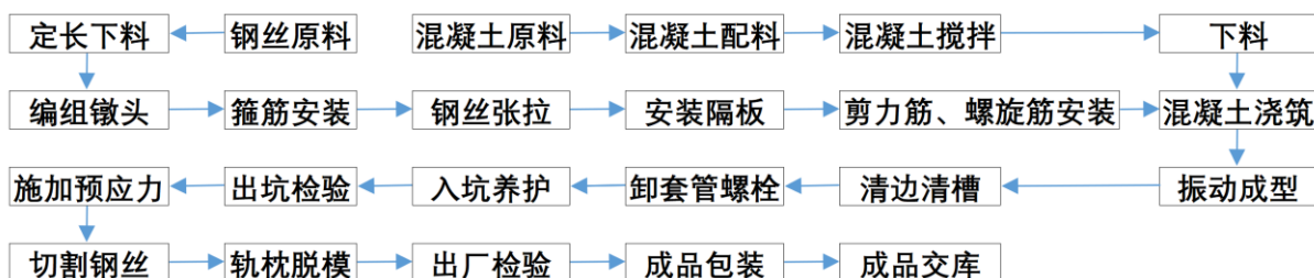
轨枕工艺流程图
