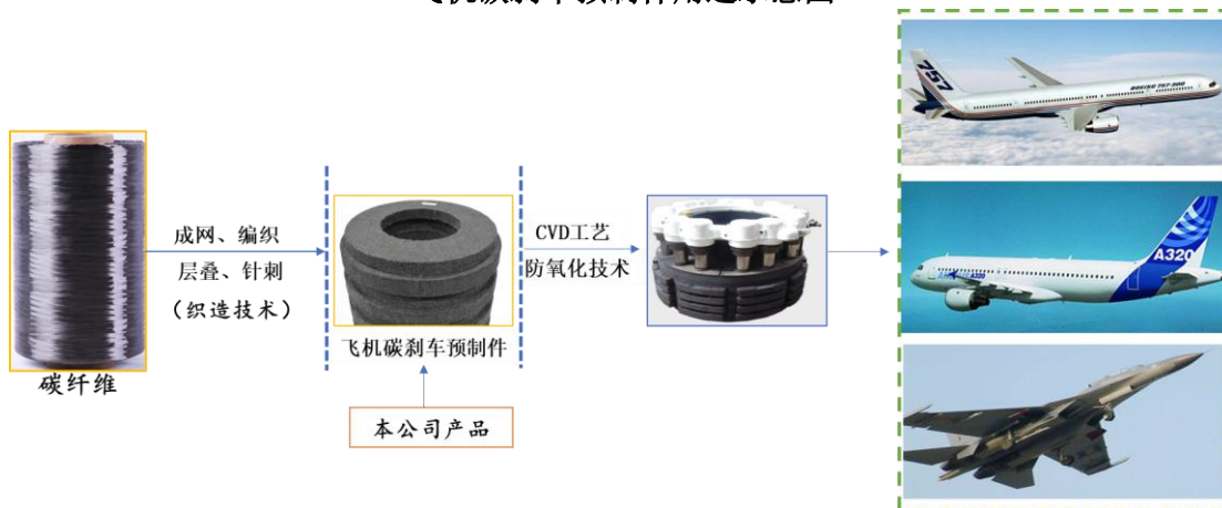
飞机碳刹车预制件用途示意图
