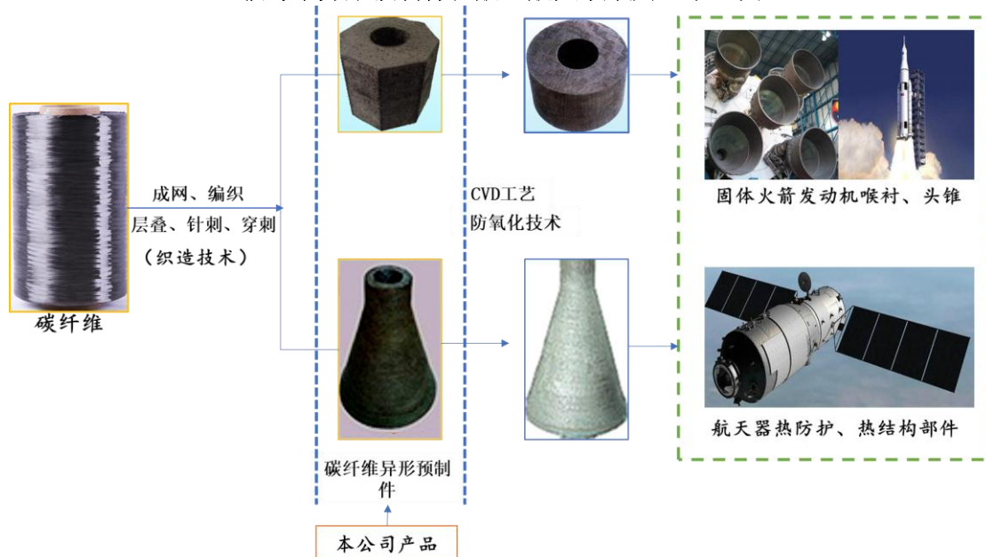
碳纤维异形预制件在航空航天领域用途示意图
