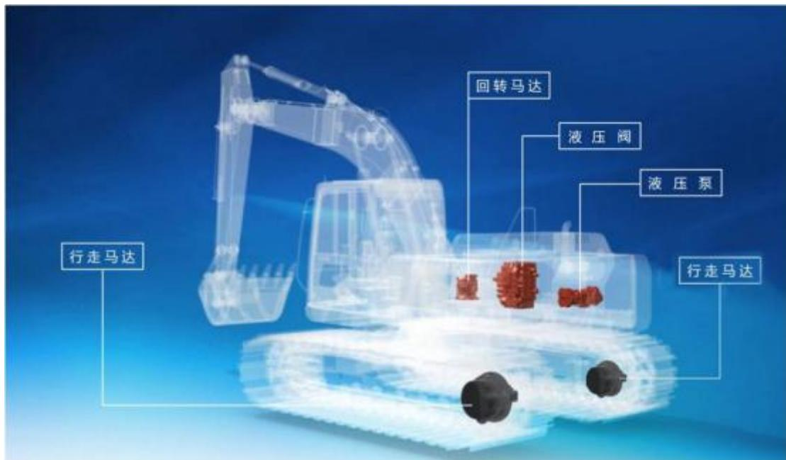
液压泵向整个液压系统提供动力；行走马达直接与液压机械的履带驱动轮或车轮相连接，驱动其直行或转向行走；回转马达一般位于液压机械的上下部件结合处，驱动上部部件旋转转向；液压阀则按操作者的指令将液压泵排出的压力油输送到各执行元件，使液压机械完成各种动作。
