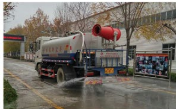
路面洒水降尘
