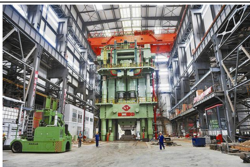
中国第二重型机械集团德阳万航模锻有限责任公司 800MN 液压机
