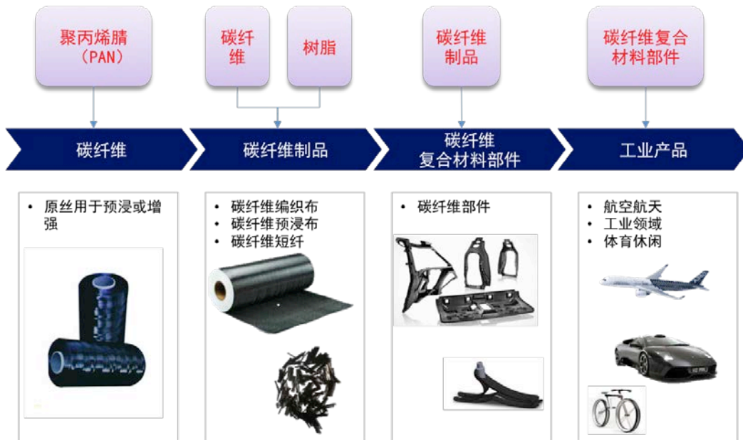
图6-5： 碳纤维产业链示意图
