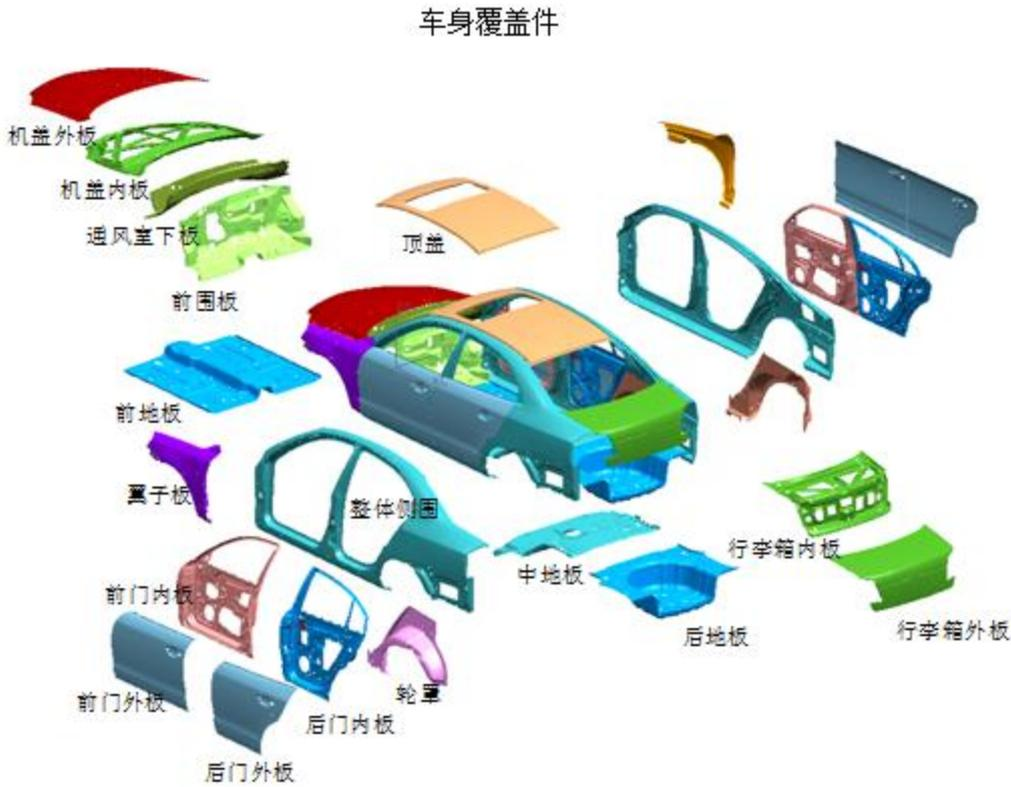
汽车覆盖件是汽车换型的主要制约因素。覆盖件制造是汽车车身制造的关键环节，按功能和部位分类，汽车覆盖件可分为外覆盖件、内覆盖件和结构件三类。
