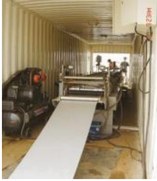
现场生产进料口
