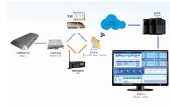
图8: 智慧空调控制技术
