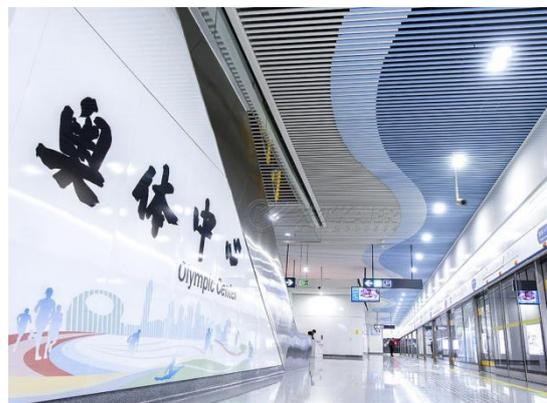
**搪瓷钢板（珐琅板）是地铁、隧道的首选装饰材料**，能够适应地铁站、机场、城市隧道、桥隧等地下空间复杂环境，综合性价比优势明显。交通枢纽人流密集、场所使用频率极高，一方面对美观性、安全性要求较高，另一方面若封停维护或改造，成本费用、涉及面影响巨大，而珐琅板易洁易维护、耐久耐气候、安全环保、长效保真等多功能优异特性使其获得了广泛应用。
