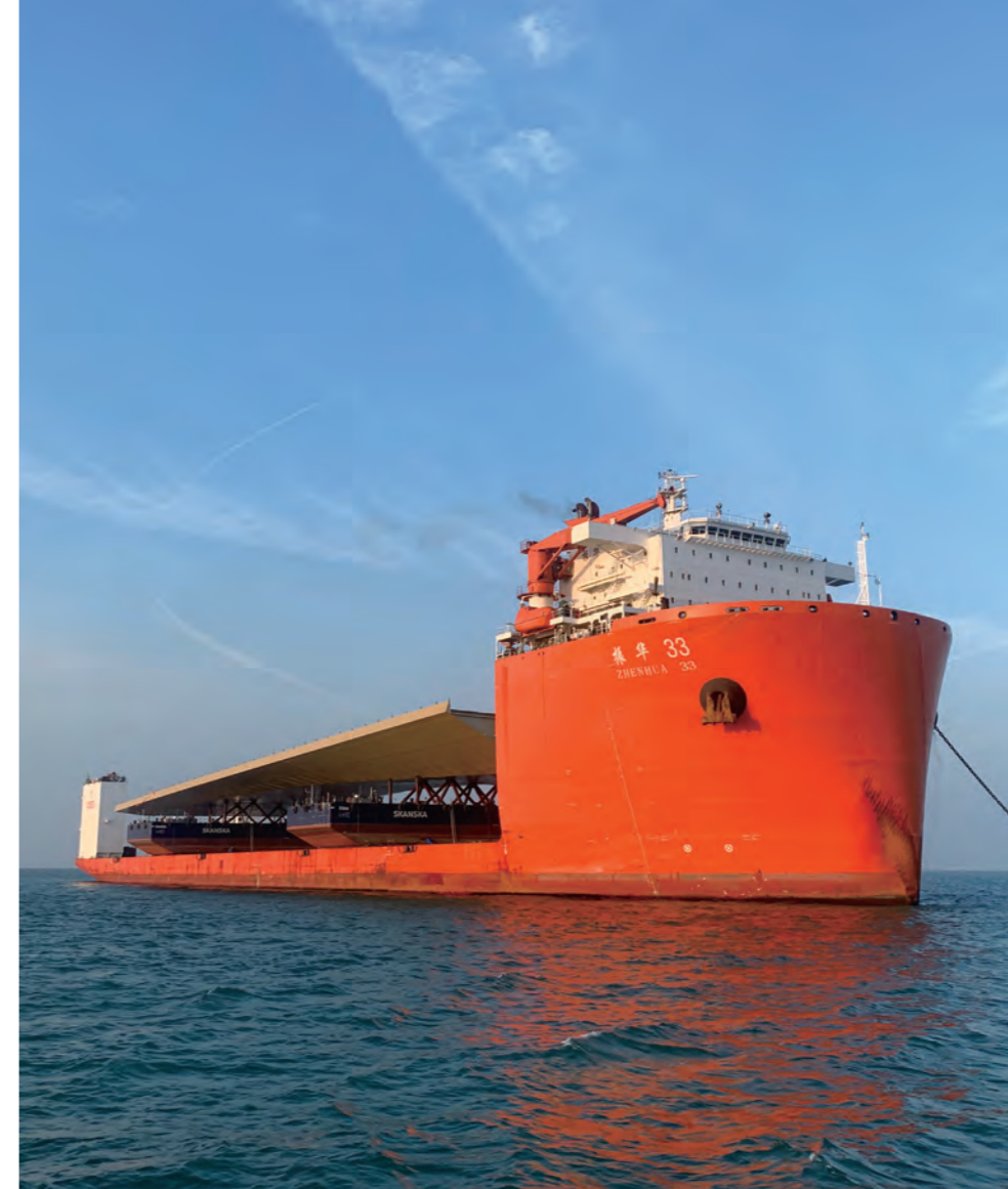
2019年底，中铁山桥制造完成了瑞典斯鲁森大桥钢箱梁大节段，大节段总重3400吨，将通过半潜船发往瑞典斯德哥尔摩施工现场架设。
