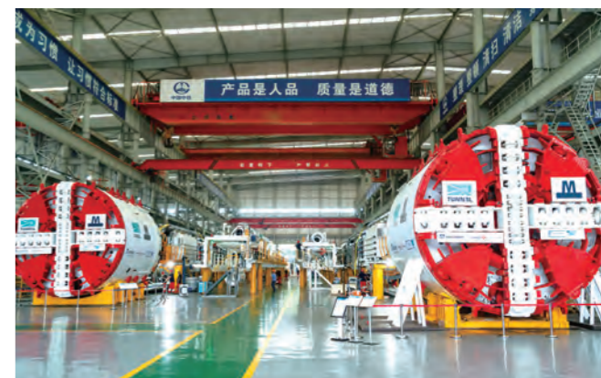
中铁装备设计制造的两台土压平衡盾构机，应用于丹麦哥本哈根地铁项目。
