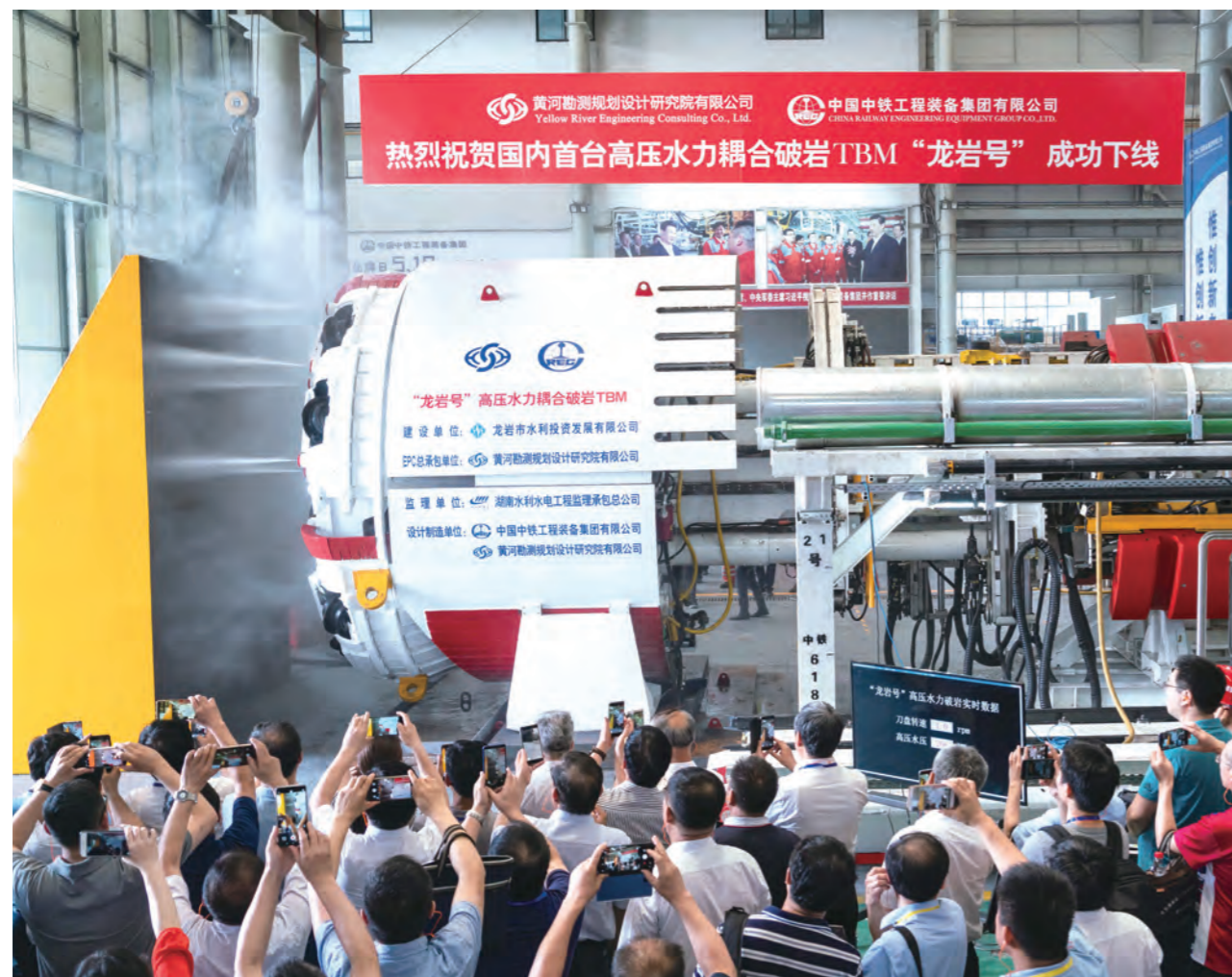
具有颠覆性意义的高压水力耦合破岩 TBM 下线，标志着世界首台第四代半掘进机问世。这一产品是对 TBM 传统破岩理念革命性的创新，真正实现了掘进机的代际更迭，不仅大大提升了 TBM 在极硬岩条件下的掘进效率，同时还将降低施工成本、加快施工进度，具有里程碑意义。
