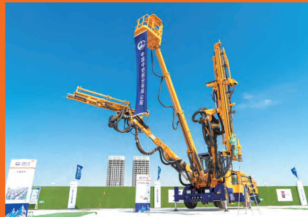
隧道钻爆孔施作的国内外技术领先的智能型三臂凿岩台车。
