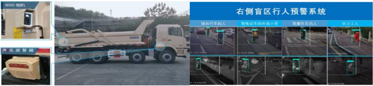
图13 渣土车盲区行人预警系统（BSD）
