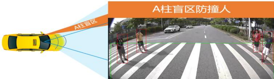
图6 出租车A柱盲区防撞人系统
