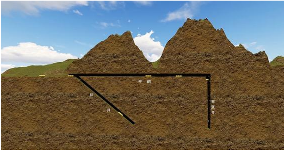
图 2： 萤石采矿开拓系统示意图
