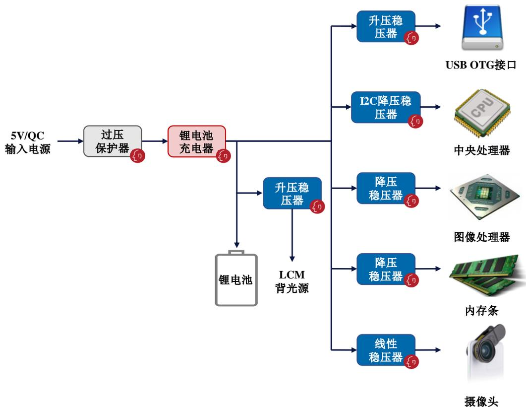
电源管理产品对于电子产品及设备整机系统的稳定运行起到了重要的作用，其性能优劣对整机性能有着直接的影响。
