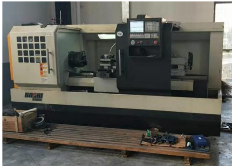
3. 数控车床 2 台；主要功能雷同于普通车床，是数字控制化的自动车床。
