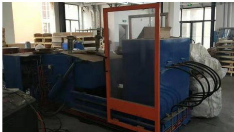
4. 试压机，卧式、立式各一台；主要进行部件的压力试验。
