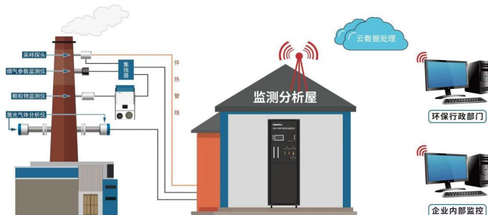
CEMS 烟气排放连续监测系统工作示意图
