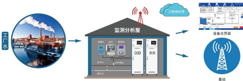
环境水质在线监测仪工作示意图
