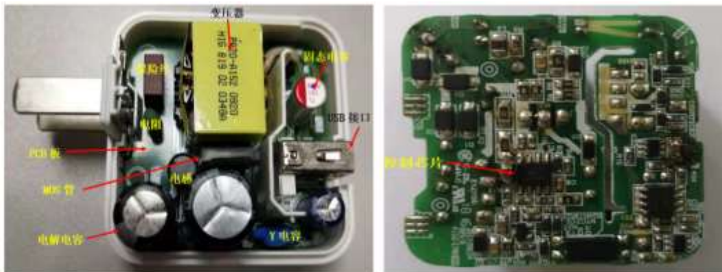
充电器内部结构图
