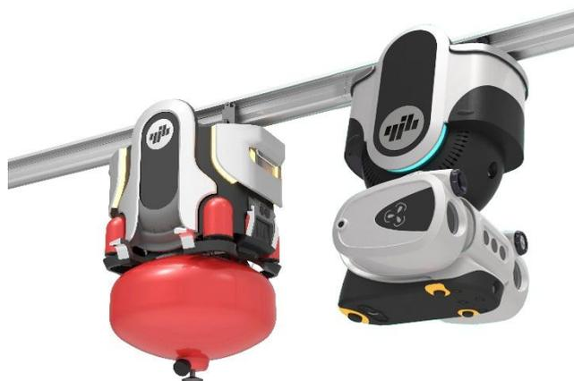
自左至右：隧道智能灭火机器人、隧道智能巡检机器人
